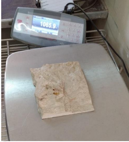
الشكل III_31: نقع العينة في الماء الشكل III_32: وزن عينة الحجاره بعد غمرها في الماء المصدر: من تصوير الطالبة الجدول III_10 : نتائج تجربة امتصاص الماء
