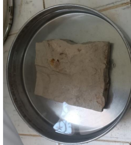
الشكل III_31: نقع العينة في الماء الشكل III_32: وزن عينة الحجاره بعد غمرها في الماء المصدر: من تصوير الطالبة الجدول III_10 : نتائج تجربة امتصاص الماء
