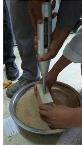
الشكل III_28: اختبار مطرقة شميدت على الحجارة الشكل III_29: المنحنى المتبع لتحديد مقاومة الضغط المصدر : ممن تصوير الطالبة
