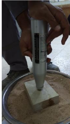
الشكل III_28: اختبار مطرقة شميدت على الحجارة الشكل III_29: المنحنى المتبع لتحديد مقاومة الضغط المصدر : ممن تصوير الطالبة
