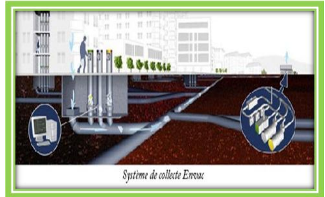
Figure 113: réseau de collecte des déchets sous terrain
