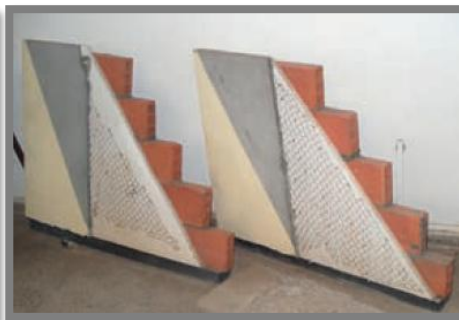
isolation par l'extérieure Parois vertical par polystyrène Source: réseau des Enterprise maghrébines pour l'environnement
