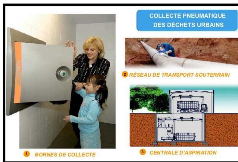
Figure N210: Collecte Pneumatique des déchets Source : www.France , Novembre 2012 p 09
