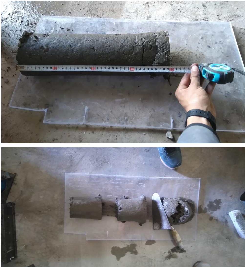
Figure.2. 6. Les différentes étapes de l'essai de mesure de l'indice de ségrégation statique.
