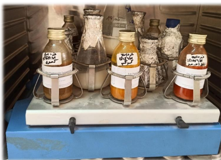
Figure 7 : Etape d'homogénéisation des échantillons au Shaker.
