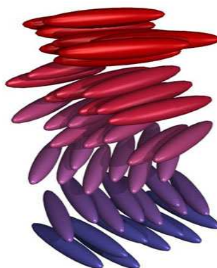
Figure I.6 : Représentation schématique de l'organisation de molécules calamitiques au sein d'une phase cholestérique.
