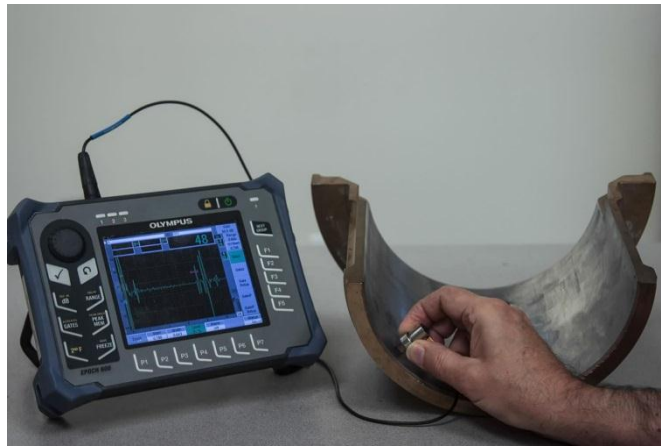
Fig. I.2 :Inspection par un appareillage de CND US portable
