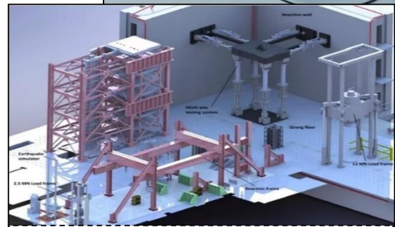
Figure 126 : essais multiaxiaux sur des éléments structuraux
