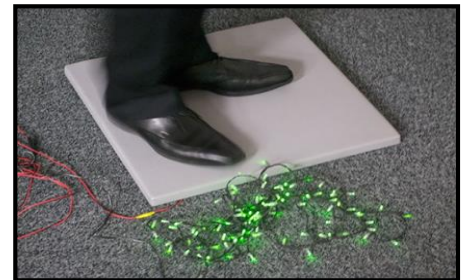
Figure 211 : : revêtement de sol qui produire électricité
