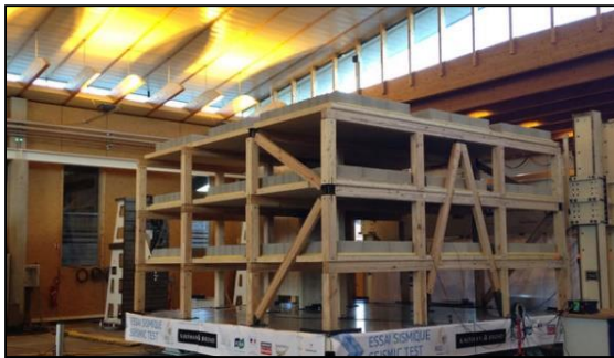
Figure 125 : une table sismique uni-axiale de 6m x 6m
