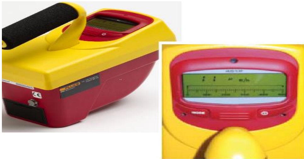
Figure (III.2) : Détecteur à chambre d'ionisation pressurisée (radiomètre) Modèle 451P [34]. CHU de Constantine.
