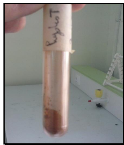
Figure 10: \text{Cu}_2\text{WS}_4 de couleur marron avec méthode hydrothermal à 200°C 72 h.
