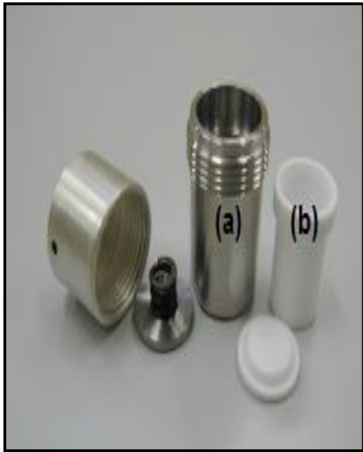
Figure 2 : Une bombe de type Parr (a) et d'une nacelle de téflon (b).
