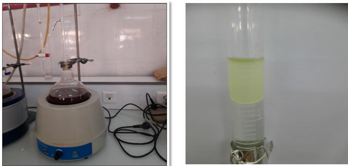
Figure 4. Technique d'extraction des HEs dans un appareil de type Clevenger.
