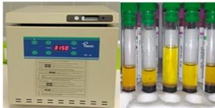
Figure 13 : Photo montrant la centrifugeuse et l'aspect des tubes après centrifugation (Laboratoire de l'Hôpital Mixte de la wilaya de Laghouat).
