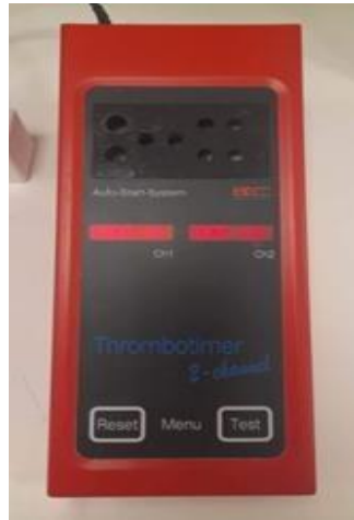
Figure 15 : Photos montrant l'appareil coagulomètre
