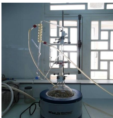
Figure 24 -photo représente l'appareil d'hydrodistillation Clevenger (Bruneton, 1993).
