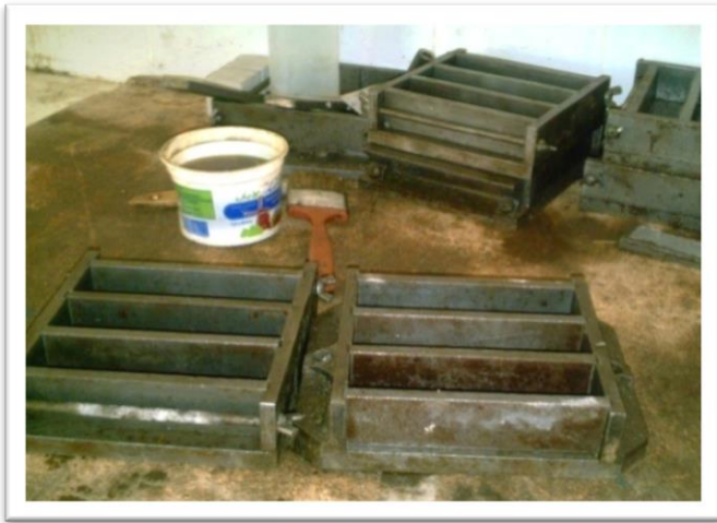
Photo 01 : Préparation, Confection et Démoulage des éprouvettes
