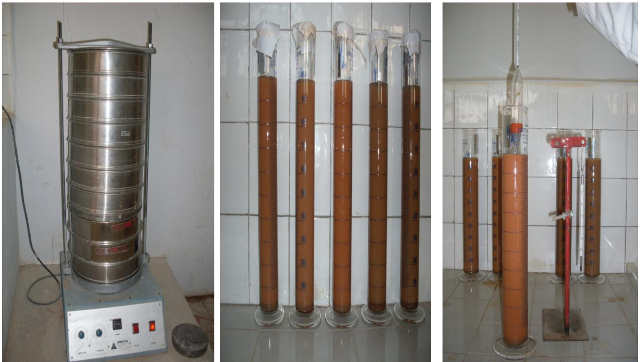
Photo 06. Analyse granulométrique par tamisage et sédimentation.
