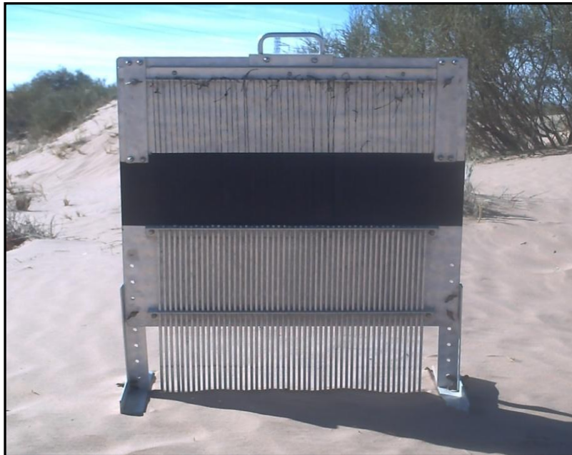
Figure 04. Appareil d'un rugosimètre à aiguille (originale)
