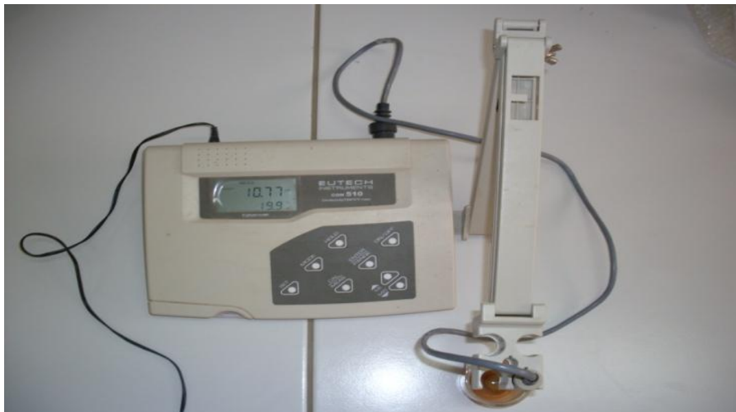
Photo 02. Mesure de conductivité électrique
