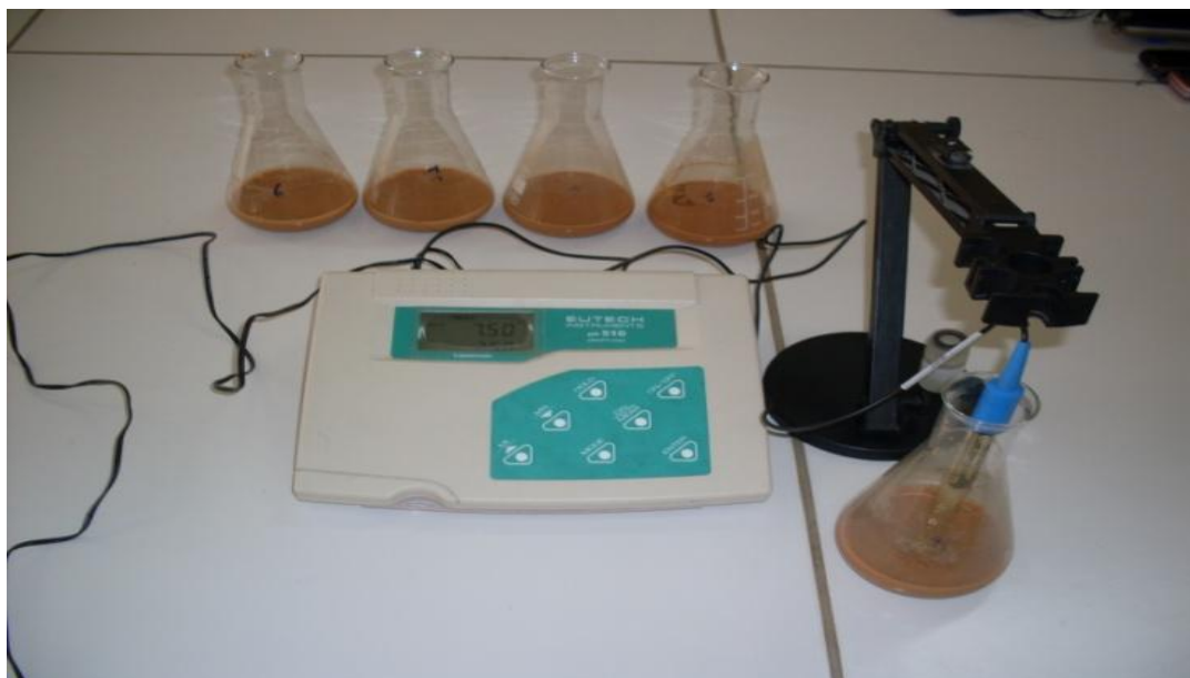
Photo 03. Mesure de pH eau par pH-mètre.
