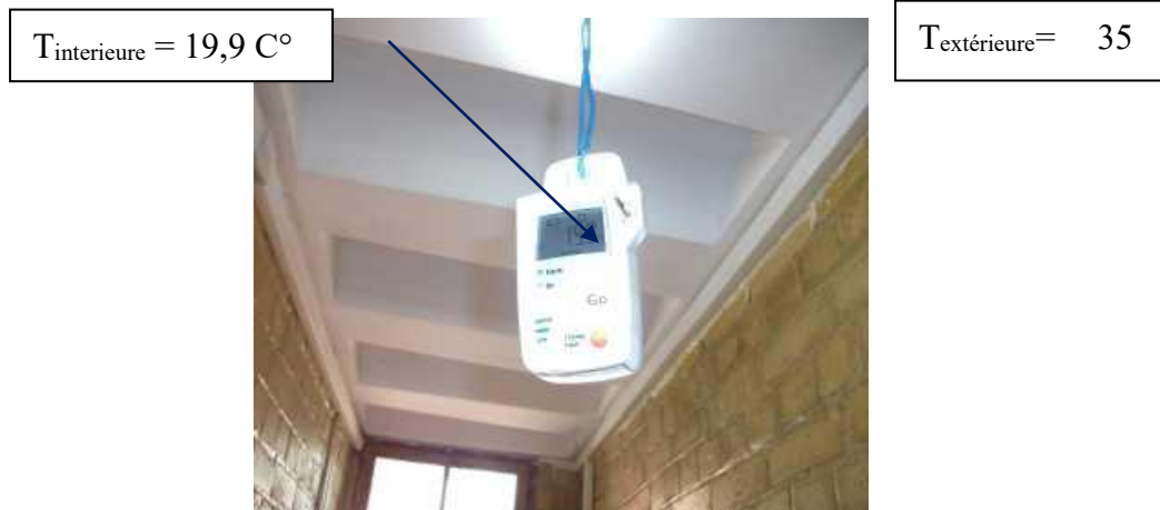
Fig. I. 14. Détection de la température à l'intérieur et à l'extérieur du prototype avec une grande efficacité énergétique [33].
