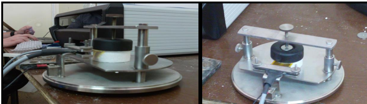
Fig II. 6.Schéma de la sonde TPS (mesure caractéristiques thermiques du polystyrène).
