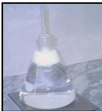
Fig II. 5. Pycnomètre rempli d'eau + échantillon.
