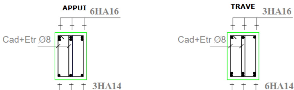
Figure 3.6 : Ferrailage de poutre (25×40)
