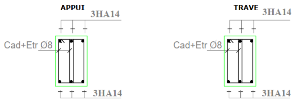
Figure 3.7 : Ferrailage de poutre (25×30)
