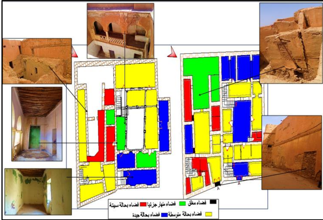
شكل 154: مخطط يوضح الحالة التقنية للمبنى المصدر : الطالبات
