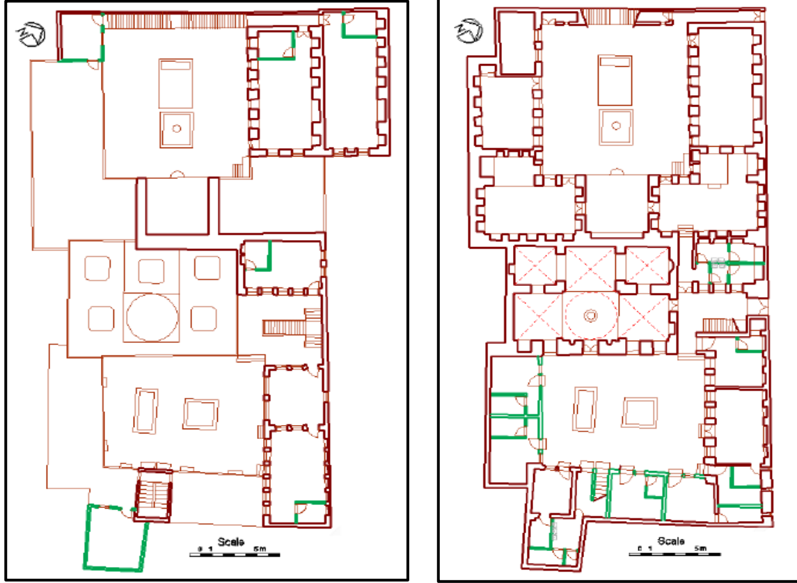
شكل 44: مختلف التغييرات التي طرأت على الطابق الارضي شكل 45: مختلف التغييرات التي طرأت على الطابق الاول المصدر: مذكرة تخرج ماجستير بعنوان اسس وظوابط عملية اعادة تاهيل المباني التاريخية في مدينة حلب القديمة.
