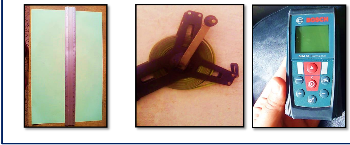
شكل 90: الادوات المستعملة في الرفع المعماري للمبنى (الديكامتر 20م ، مسطرة قياس 30سم .) المصدر: الطالبات
