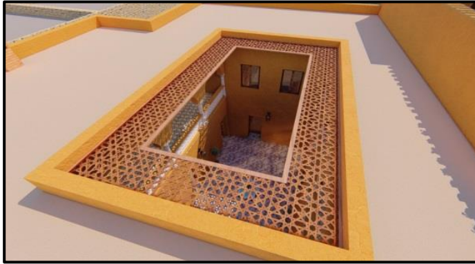
شكل 184: استعمال غطاء خشبي لحماية الجدران والتظليل. المصدر: الطالبة
