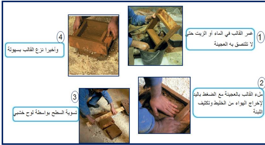
شكل 116: يوضح عملية تحضير الطوب المصدر: الطالبات
