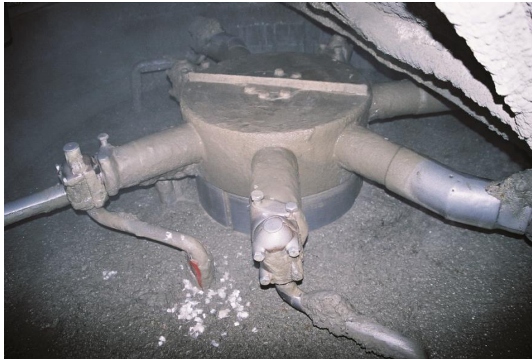
Figure I-11: Vue intérieure d'un malaxeur de centrale à béton.[15]
