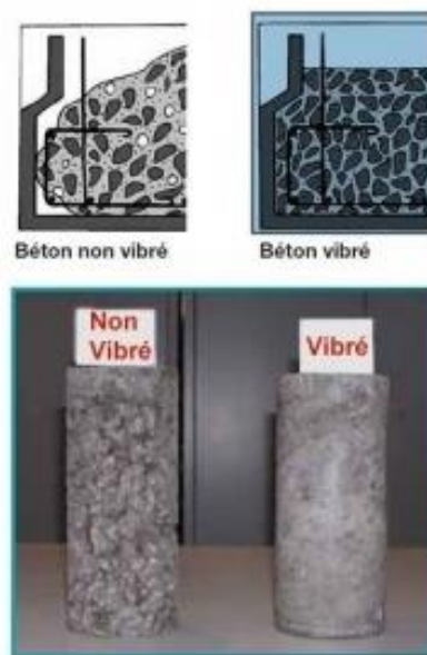
Figure I-12 : Influence de vibration au béton.[14]
