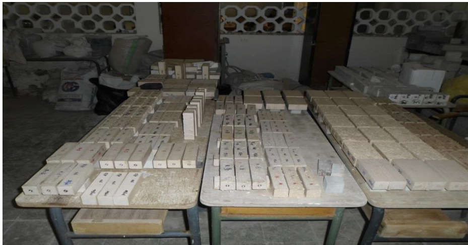
Figure A-8.2 : Différentes échantillons distingué à la caractérisation physico-mécaniques et thermique.
