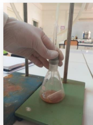
Lecture du \text{CaCO}_3 par le volume du \text{CO}_2 dégagé
