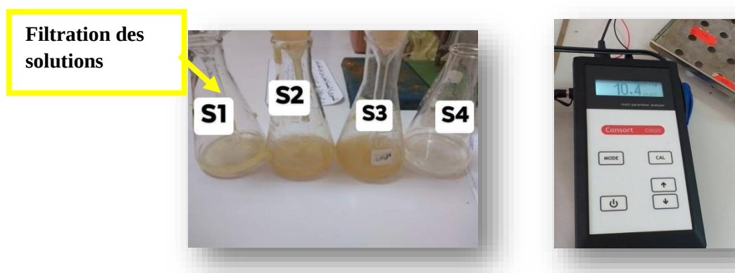
Figure 24: Photos représentatives la filtration des solutions et d'un multi-paramètres de type Consort (mesure du pH et CE).
