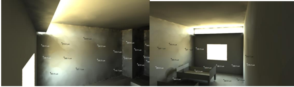
Figure 246 ; Figure 247 niveaux d'éclairement
