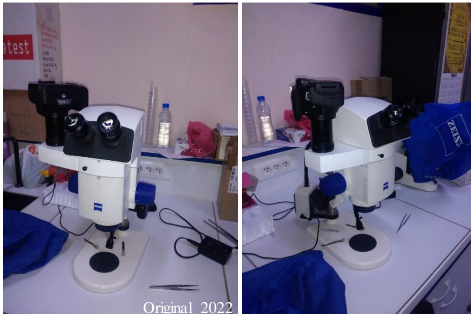
Figure 7 Loupe binoculaire équipée d'une caméra utilisée dans la mise en évidence de la banque de graines du sol par technique directe.
