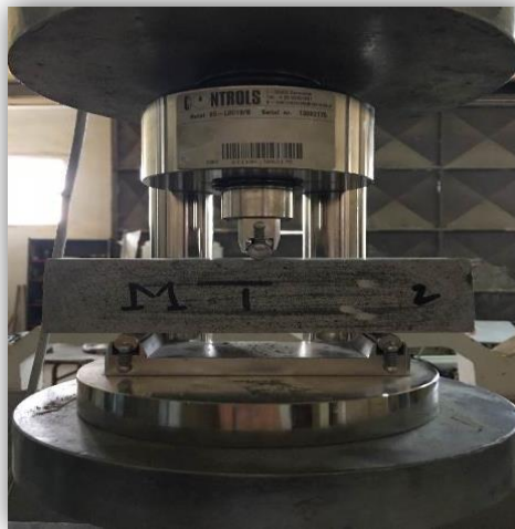
Figure II.7. Dispositif de l'essai de flexion trois points.
