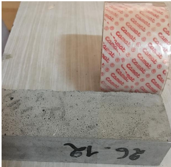
Figure II.14. Protection des éprouvettes par un film plastique adhésif.
