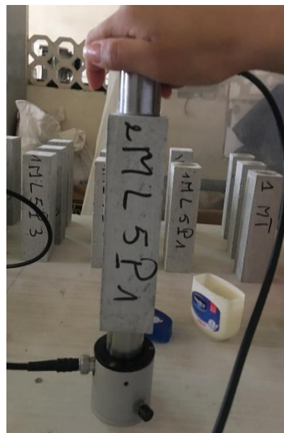
Figure II.6. Appareil d'auscultation dynamique (ultra sonique).
