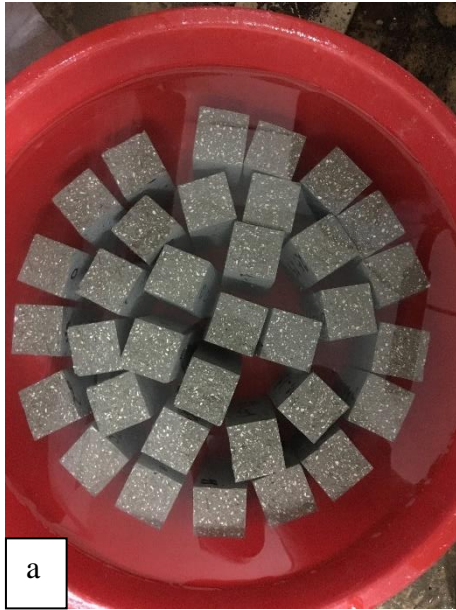
Figure II.16. Saturation et séchage des éprouvettes cubiques pour l'essai de la porosité totale
