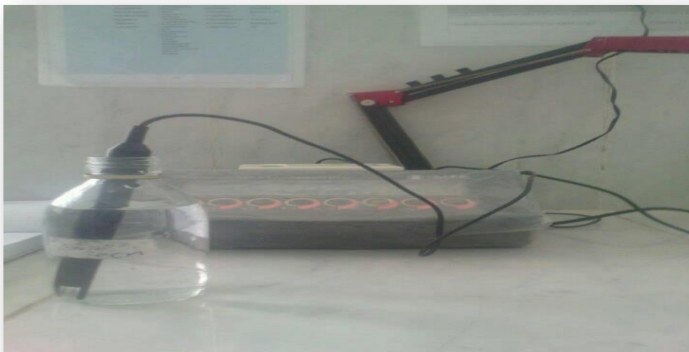
Photo3 : Détermination du pH
