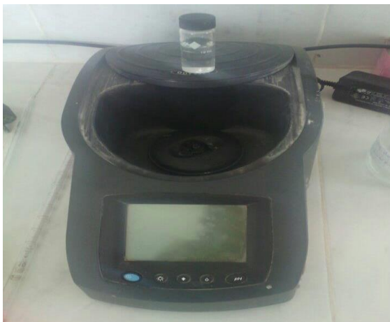
Photo9: Dosage des nitrates par spectrophotomètre UV visible
