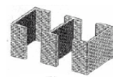
Prendre en compte le retrait durant la conception et durant la construction
