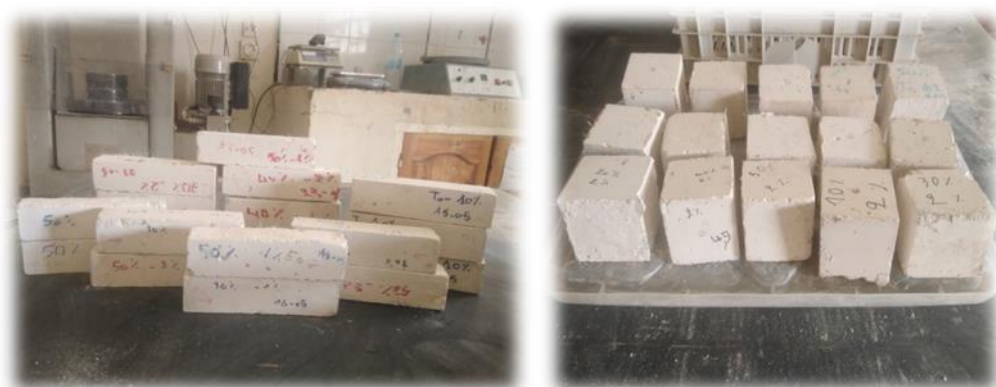
Figure. II.12. Conservation des épreuves de mortier de plâtre au laboratoire.
