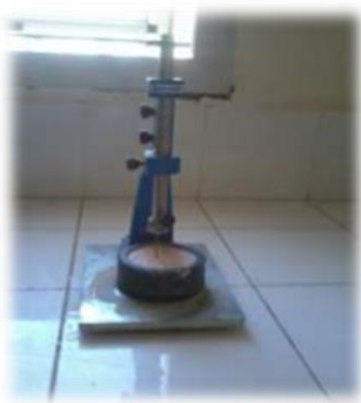
Figure. II.3. Détermination de temps de pris par appareil de Vicat.
