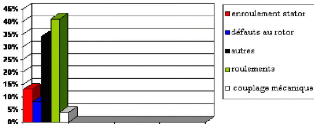
Figure II.6 : Répartition des pannes des machines de fortes puissances
