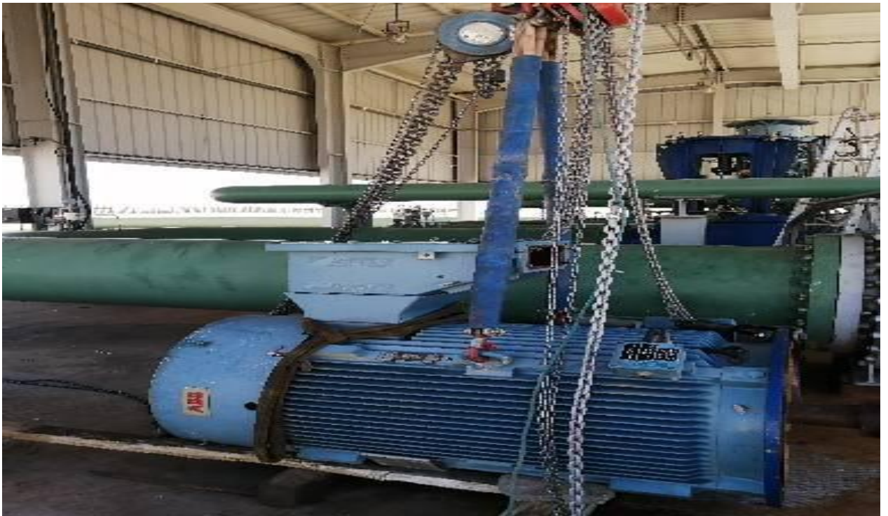
Figure III.4 : machine asynchrone utilisé pour l'analyse vibratoire [3]
