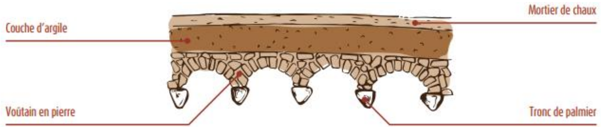
Figure 3 -11 plancher en vouitains .Source OPVM
