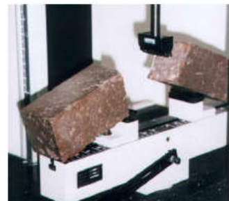
Figure 3.7 : Mode de rupture des éprouvettes prismatiques de BCR en flexion
