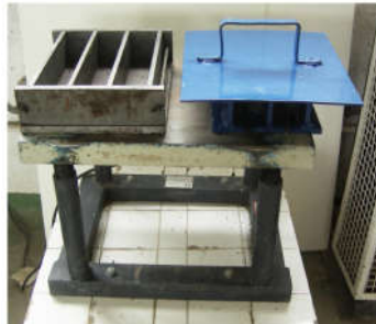
Figure 3.6 : Moule et charge conçu pour la confection des éprouvettes prismatiques ( 7 \times 7 \times 28 ) de BCR
