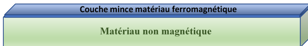
Figure 9 : Multicouche magnétique constituée avec en alternance, un métal ferromagnétique M ( Fe , Co , Cr... ) et un matériau non magnétique M' ( Au , Cu , Ag, ... ).
