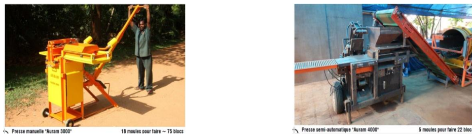
Figure. IV. 7. Les équipements pour construire en terre
