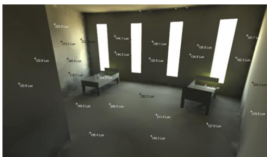
Figures 145 : Niveau d'éclairage.
