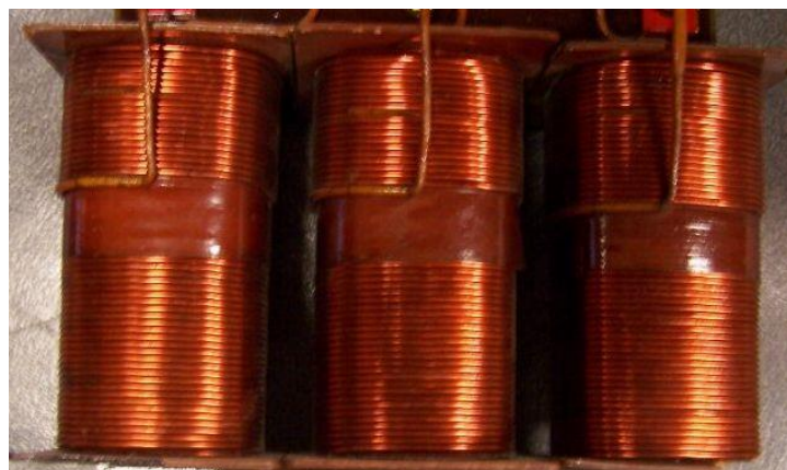
Figure I.2 : Circuit magnétique et disposition des enroulements
