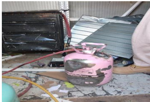
Figure 11. Bouteille de soudage oxyacétylénique modifié.
