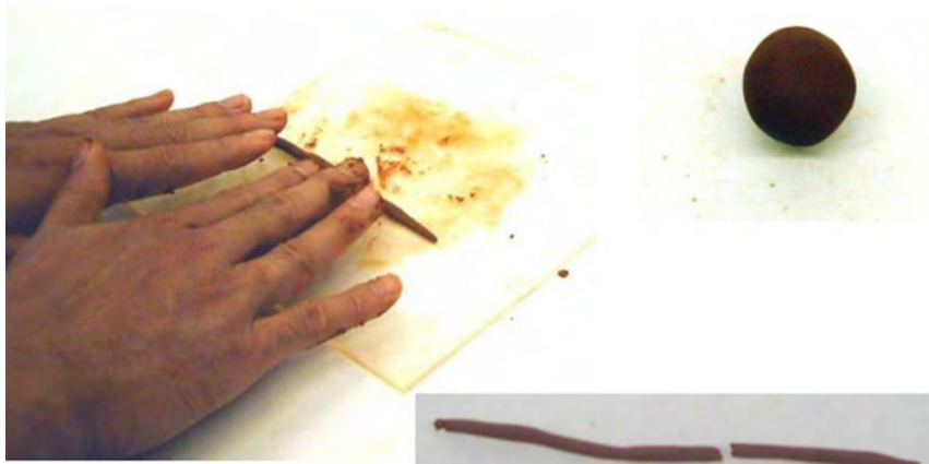
Figure III.12 : Détermination de limite de plasticité.
