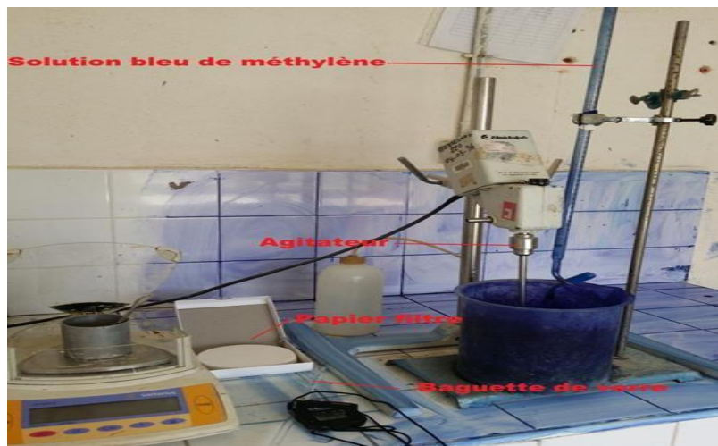
Figure III.13 : Appareillage de l'essai bleu de Méthylène.
