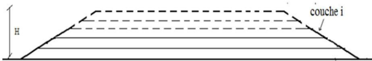
Figure III.7 : Phasage de la construction par couches.
