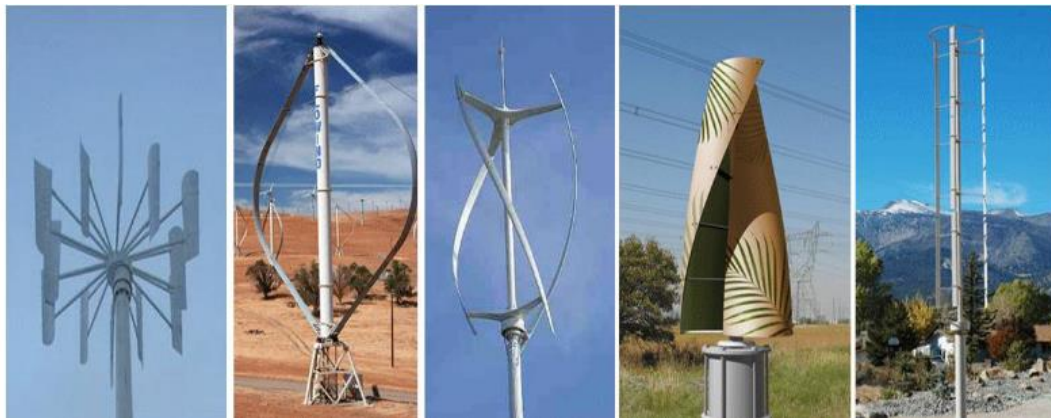
Figure I.6 : Petites éoliennes à axe vertical [14].
