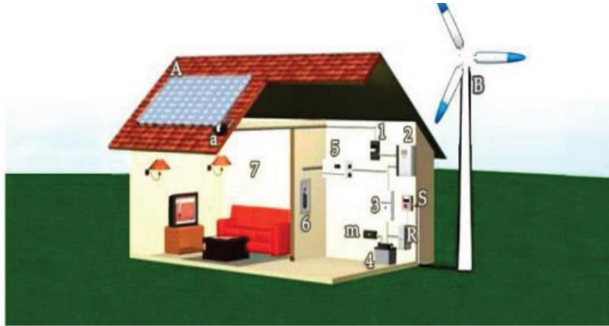
Figure I .12 : Système d'énergie hybride photovoltaïque-éolien [21].
