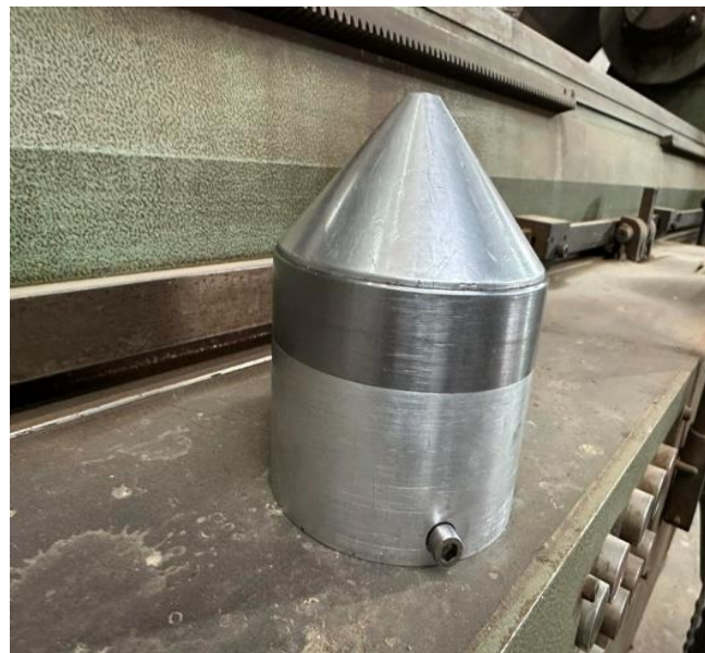
Figure III.3 : Perçage, lamage et filtrage.
