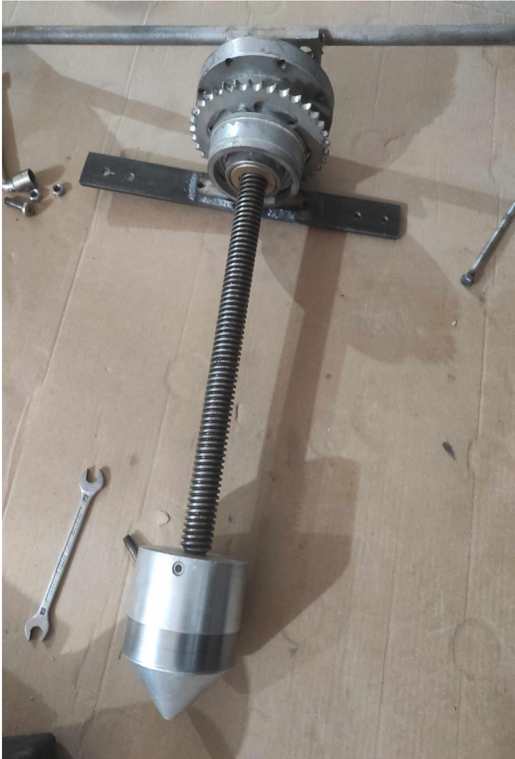
Figure III.4 : Fixation de la vis et le piston par goupille.
