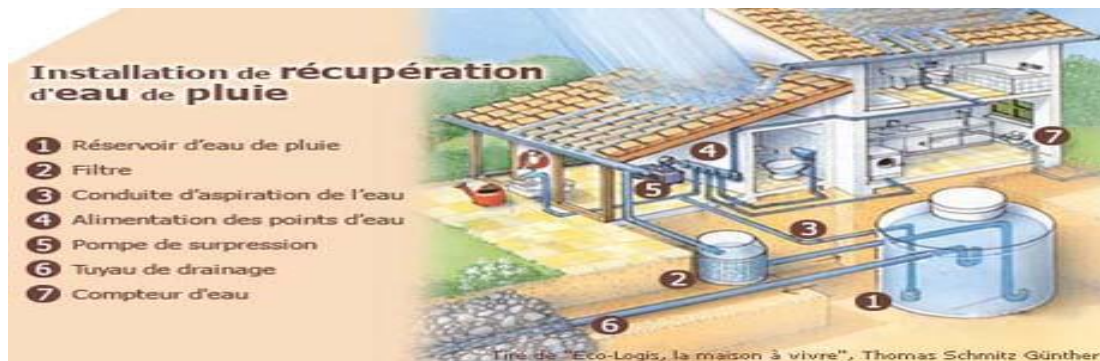
Fig : système de récupération des eaux pluviales dans le projet
