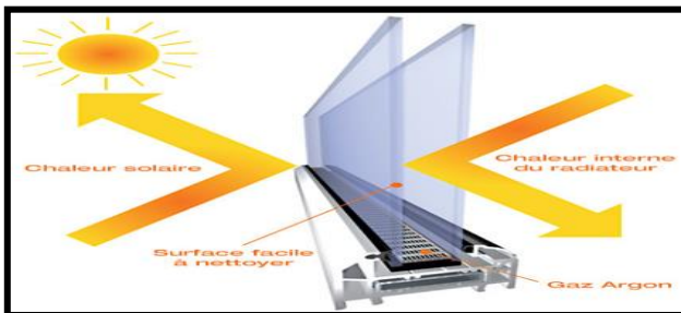
Figure: Double vitrage : composants et numérotation des faces
