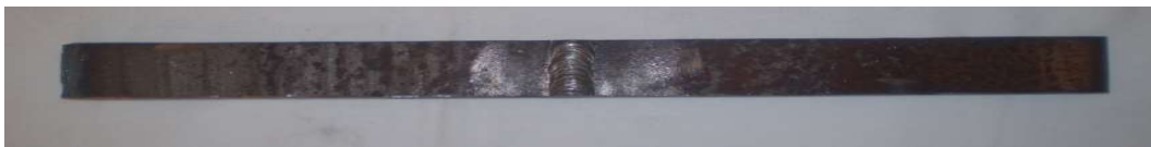
Figure 3.4 : Eprouvette de de traction retirée du pipeline X70, l'axe de chargement est perpendiculaire au cordon de soudure et le renfort de soudure est laissé intact
