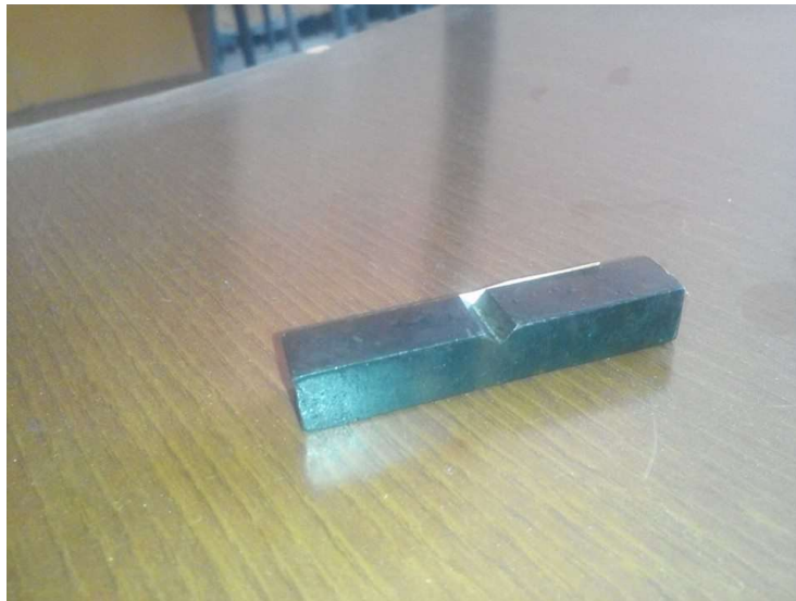
Figure 3.7 : Les éprouvettes pour l'essai de résilience normalisées.
