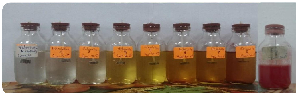
Figure III-1. Pièces de la fonte ductile en suspension dans les solutions inhibitrice.
