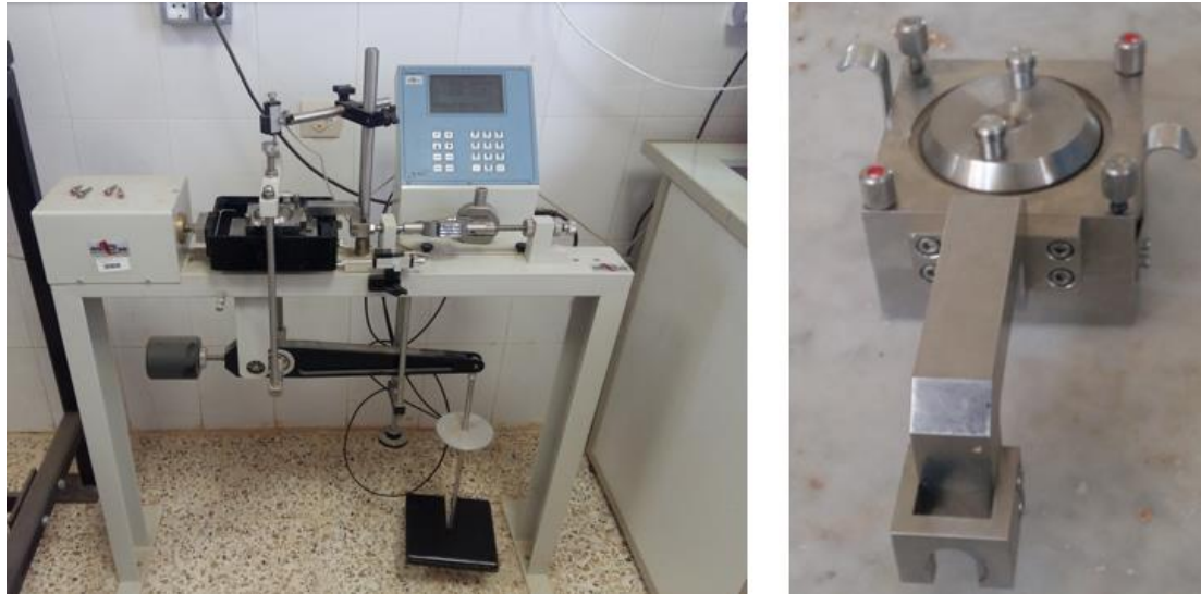
Figure 9 : Dispositif de l'essai de cisaillement direct
