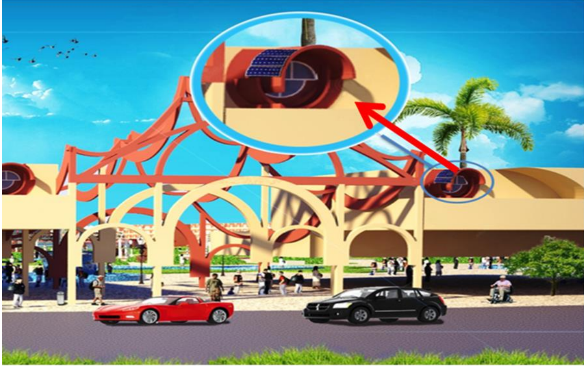
صورة رقم (40) : توضح تركيب الألواح الشمسية على مستوى النوافذ المصدر : من اعداد الطالب
