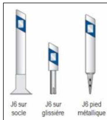
Figure II.21 : Type de balise latéral délinéateur J6
