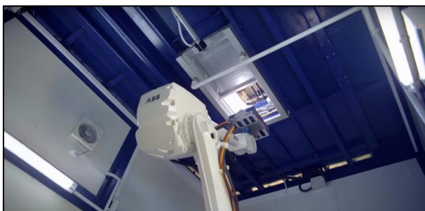
Photo 45 un système automatisé pour le mise en place du colis sur le drone
