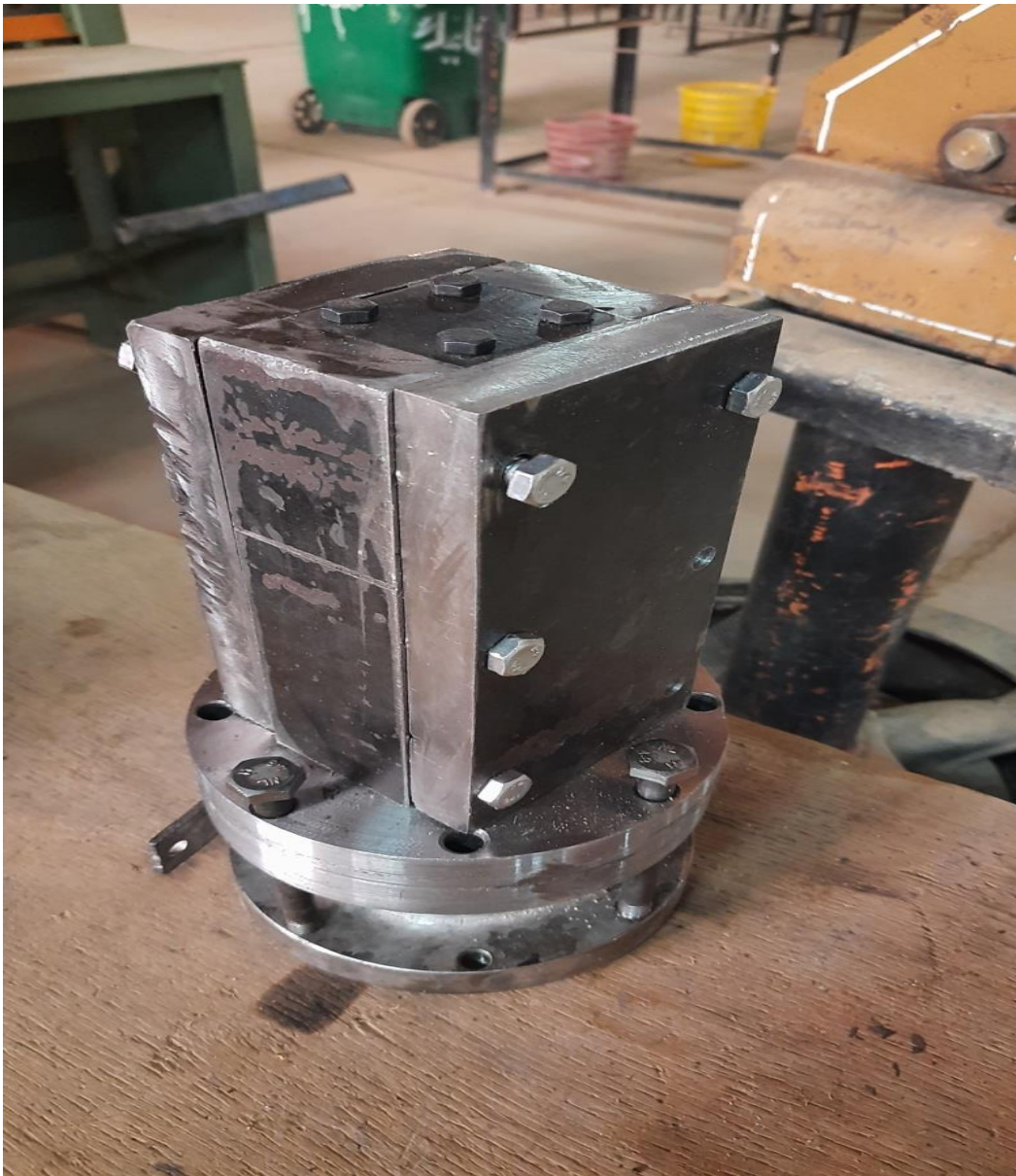
Figure III. 3: Assemblage d'un moule
