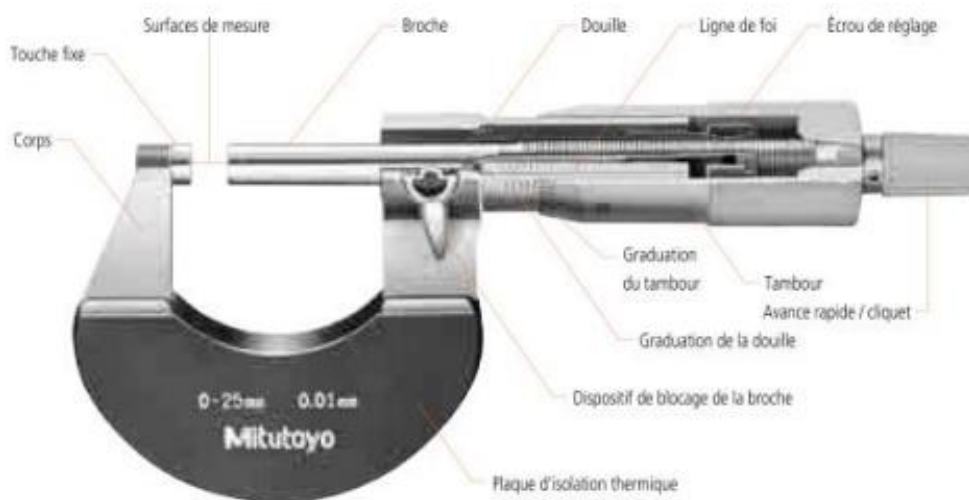
Fig.I.44 : Micromètre d'extérieur analogique standard.
