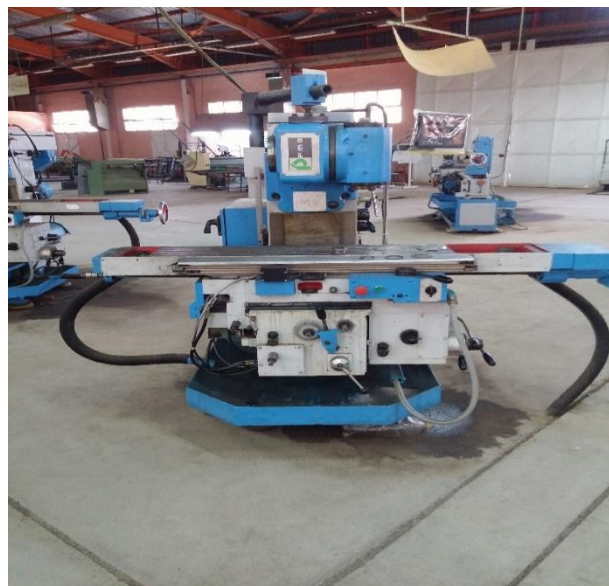
Fig.I.19 : Fraiseuse à axe vertical.
