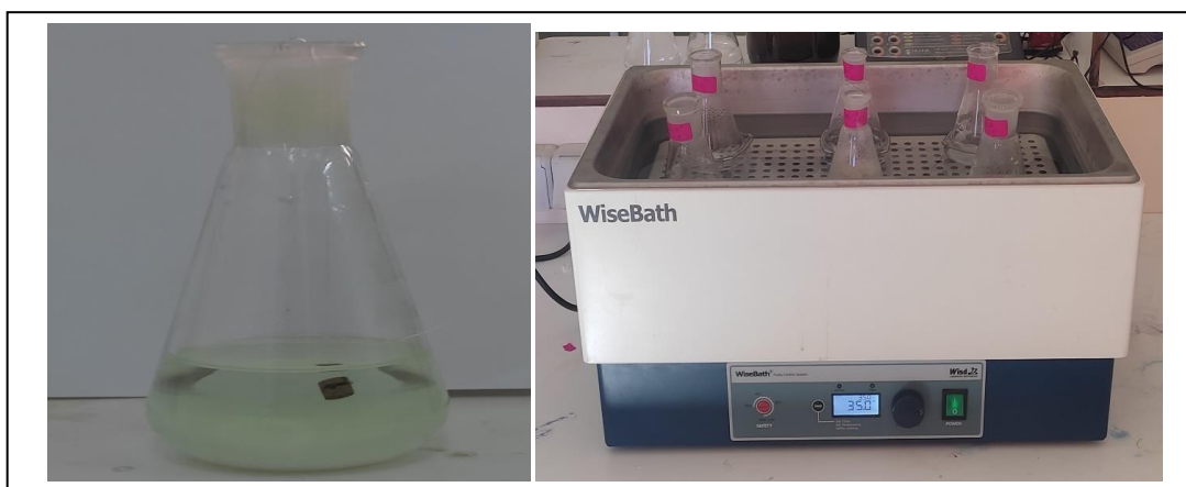
Fig.2 Dispositif expérimental de la méthode gravimétrique
