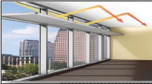
Figure 155 : fonctionnement d'un lightshelf Source : www.energieplus.com
