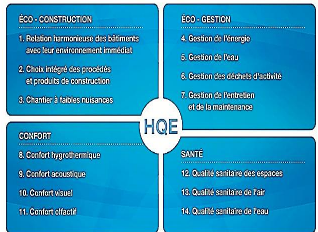
Figure 1 : les 14 cibles de la HQE source : PDF les 14 cibles de la HQE
